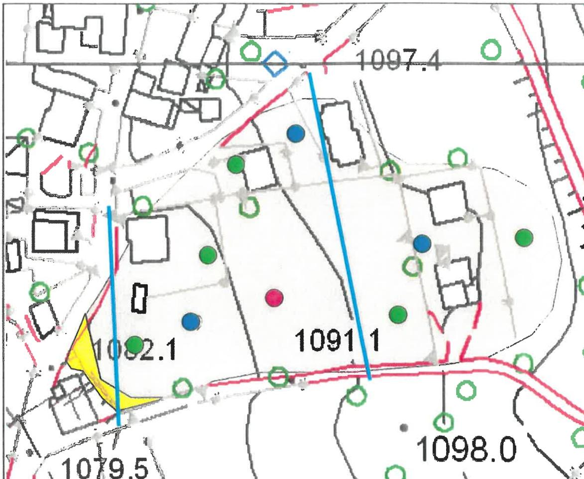
● Sondaggio geognostico a rotazione e carotaggio continuo con piezometro e prelievo di campione sulla coltre di copertura da sottoporre a prove di laboratorio geotecnico
